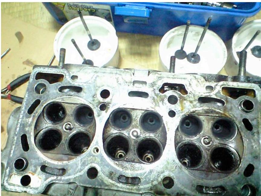
バルブが元の位置に必ず戻れるよう、仕分けて保管します。
