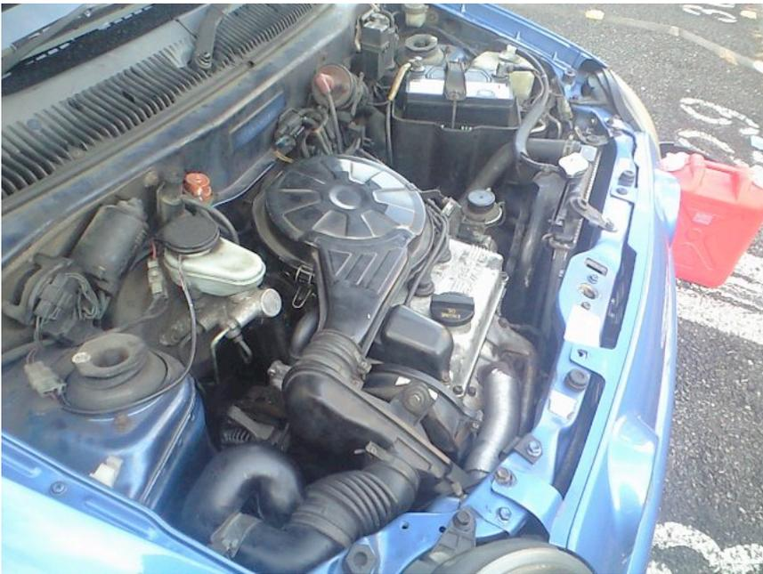
その後、LLCを充填して火入れを行いディストリビュータの点火位置を調整します。一番エンジン回転がスムーズになるところで調整しました。写真なので音が伝わりませんが、無事、厳かにエンジン稼働中です。
