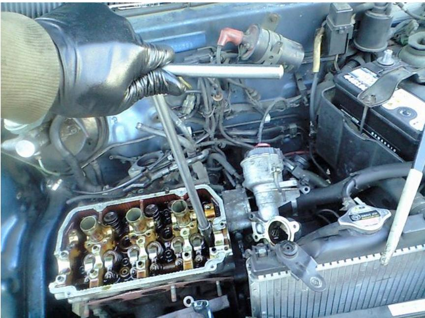
で、ヘッドのロッカーアームシャフト、カムシャフトを外したら、いよいよ総本山のお出し、8本のエンジンボルト。固着のみが心配です。取り外しは均等な負荷になるよう、内側から外側へと対角に同トルク程度ずつ緩めてゆきます。
