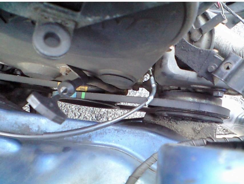
クーラー、発電機のベルトを取り外します。ここはボルトでベルトの張り具合を止めているので、そのボルトと機器の下のボルトを緩めればローターが前後に動きます。クーラーは下にボルトが2箇所、発電機は1箇所ありました。
