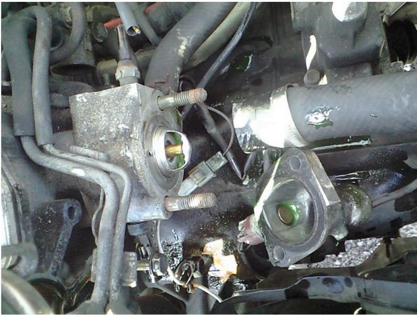
冷却ホースを外すとサーモスタッドが見えてきます。エンジン温によって冷却水をバイパスあるいはラジエーターへと循環させるパーツです。これはポロッと取れます。
