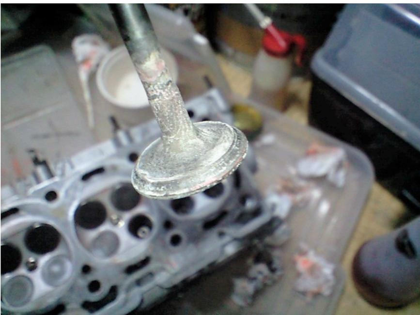
擦り合わせ前のバルブです。メタルクリーンでも落ちきらないバルブ面のこびりつきは擦り合わせることで面を出します。
