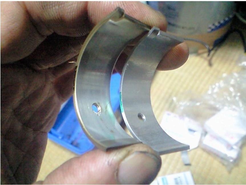
コンロッドベアリングの新旧比較。手前が35万キロ走破のベアリング。マイクロメーターで測ったところ、新品と全く同じ厚みだったので、オイル管理は良かったようです。ただオイルホールにカジリがあるのでこれも交換です。
