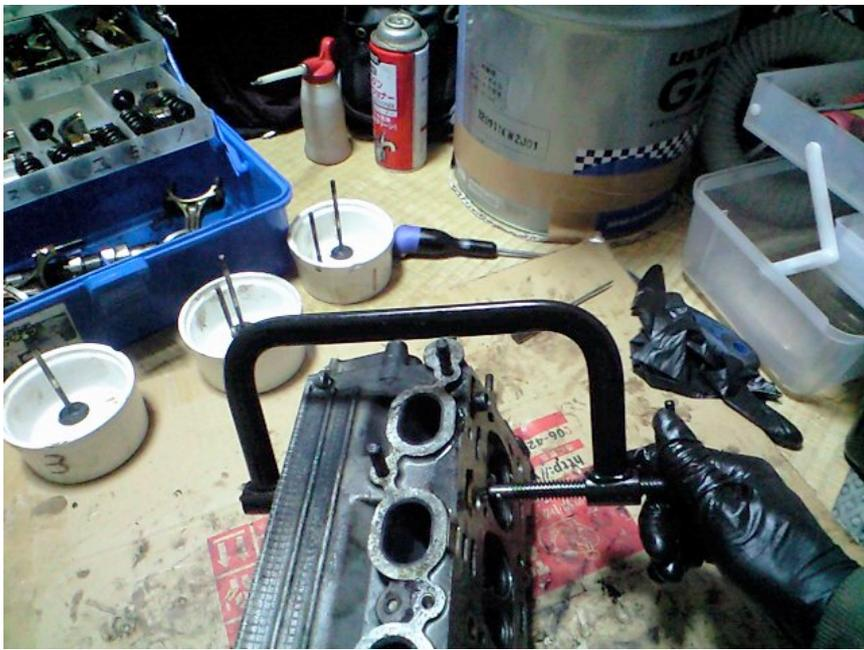
スプリングテンショナーでスプリング内の留め具コッターを外して、バルブが外せるようにします。
