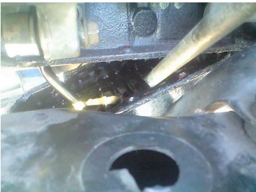
ボルトを外してもオイルパンは液体ガスケットでくっついてますから、マイナスドライバーを慎重に差し入れて剥がします。でも曲線パイプのオイルストレーナーを外さないとオイルパンが取れないのでこの状態で先にストレーナーを取り外します。それはボルト2つ止めでした。
