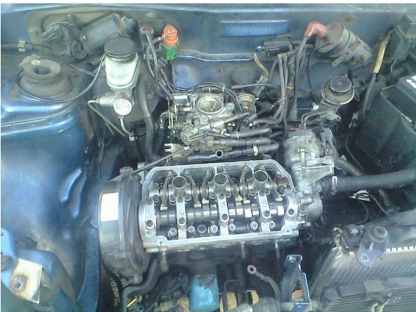
エンジンオイルを規定量入れ、カムシャフト、ロッカーアームを取り付け、ゆっくりクランクを回します。回転の不具合、締め忘れ、付け忘れ等の最終チェックです。
