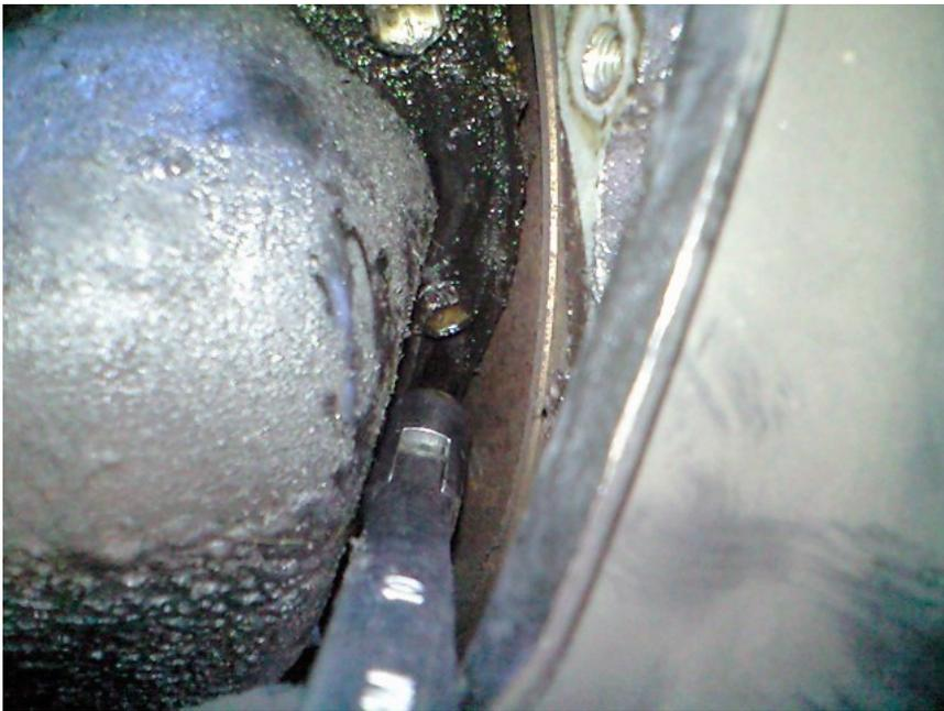
そしてオイルパン最奥2カ所のボルトもこれでアクセスできます。ボルトにはめて、レンチの反対側をプライヤーで挟んでひねります。角度が制限されますので僅かずつですが時間をかけて外します。逆に取り付けるの大変そう。
